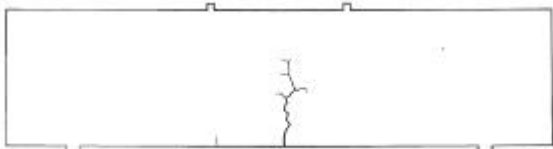
図12 FVMによる破壊直前の変形モード (No.3試験体)
